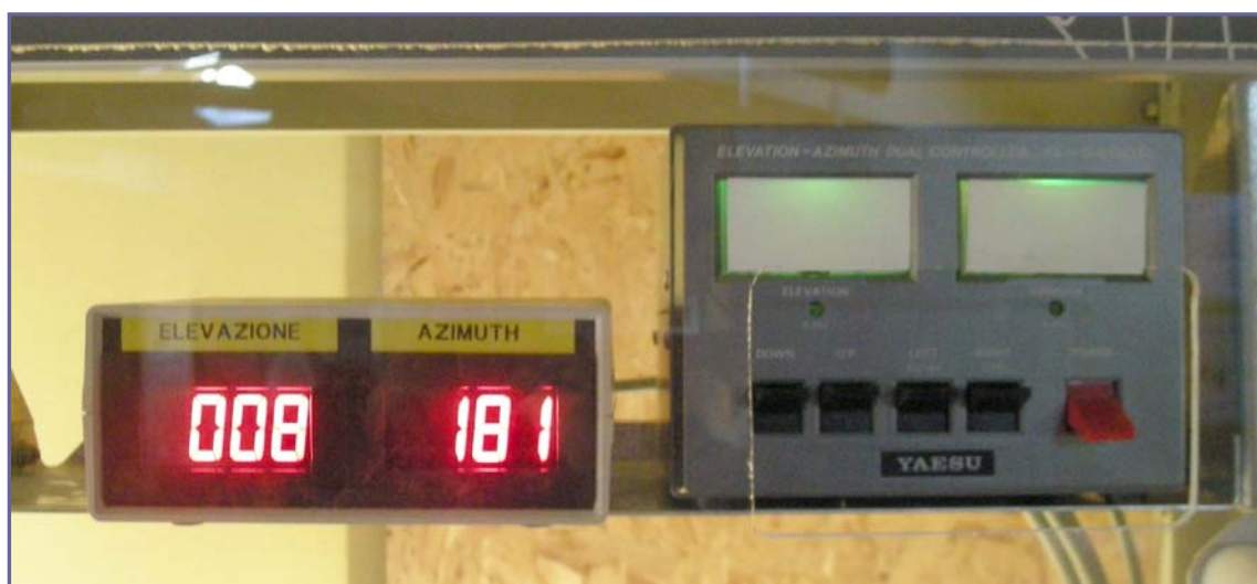
Figura 3 : l'unità di Controllo Rotori con a fianco i Display digitali
