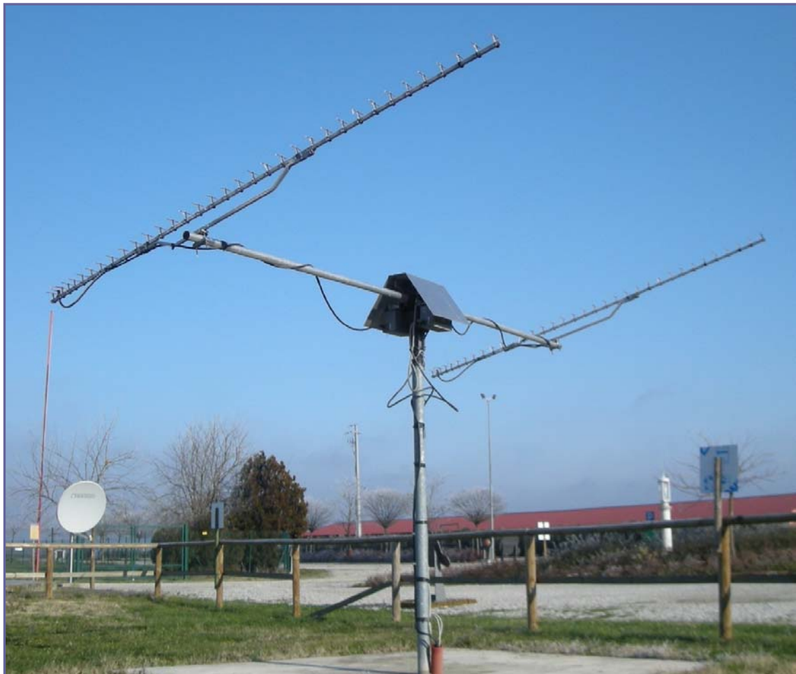
Figura 1 : il sistema ricevente dell'Interferometro Didattico di Medicina
